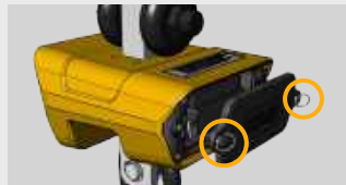
1. 핸드 볼트를 돌려 배터리 커버를 탈착합니다.
