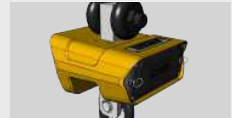
5. 배터리 케이스와 팩을 제품에 넣고 배터리 커버를 덮은 후 핸드 볼트를 체결합니다.
