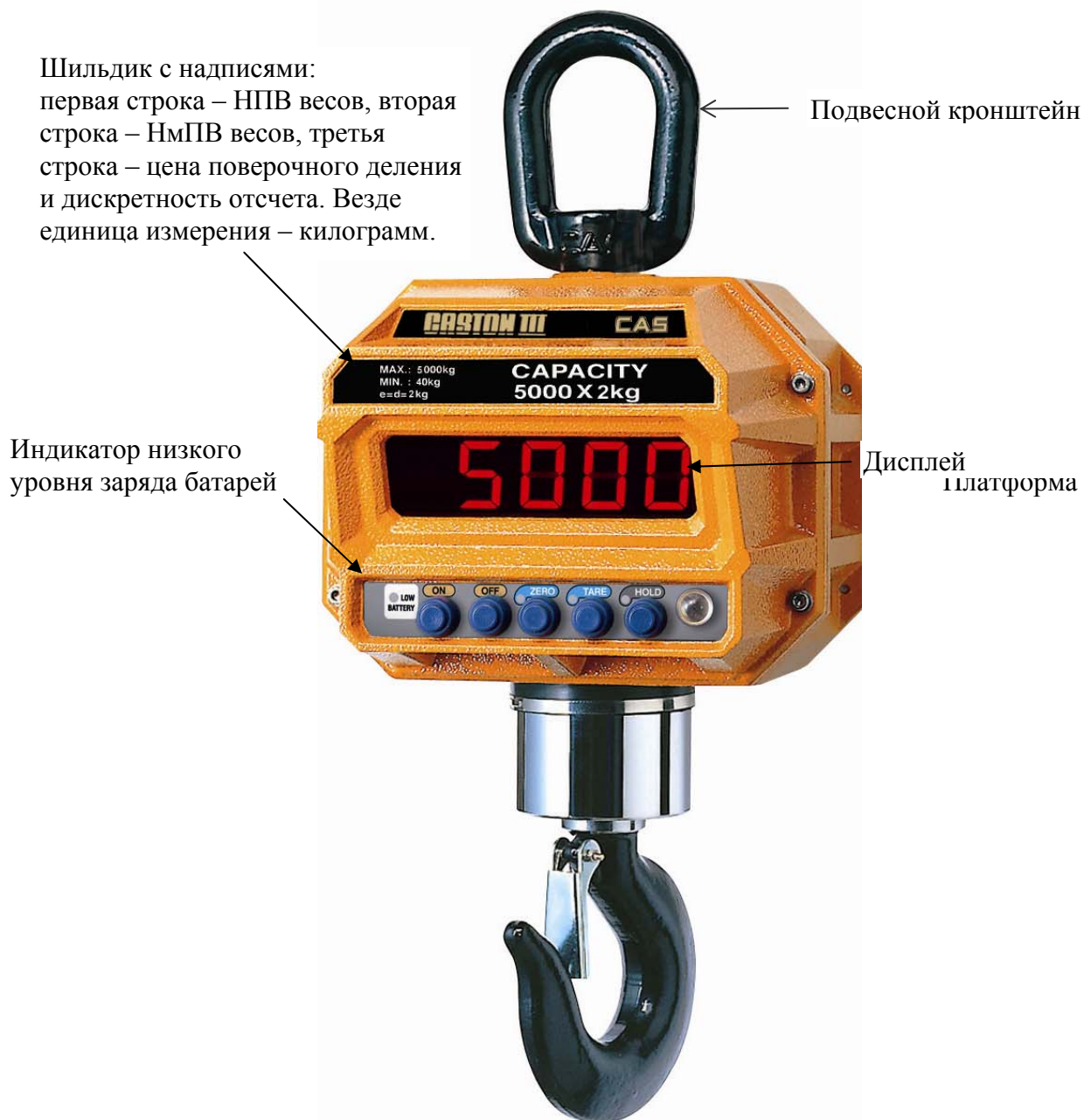
Рисунок 4.1 – Общий вид весов, основные элементы
